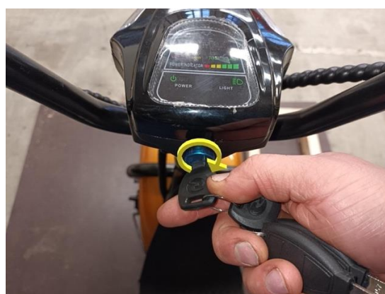
Käytä virtoja päällä ilman, että akku on kytketty Kruiseriin noin 15 sekunnin ajan. Näin ohjainlaitteessa oleva jäännösvirta purkautuu.
